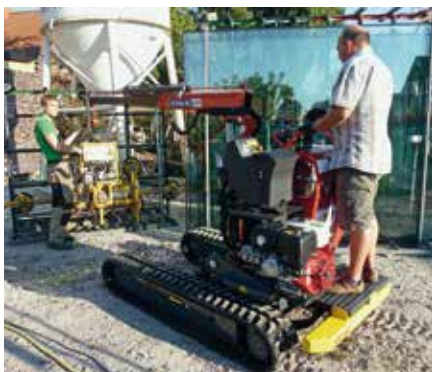
Schritt 1: Laden Sie das Raupenfahrzeug ab, hängen Sie den Vakuumsauger an den Kranearm und fahren Sie das Gerät zum Glasreff.
